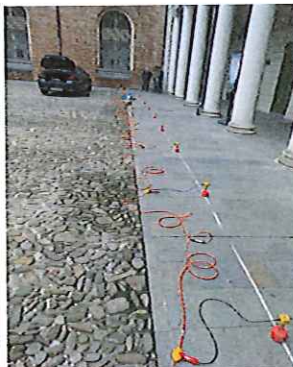
Foto 9,10,11 - Esecuzione di prova sismica ESAC (n° 2) : stendimento geofonico e acquisizione dati.
