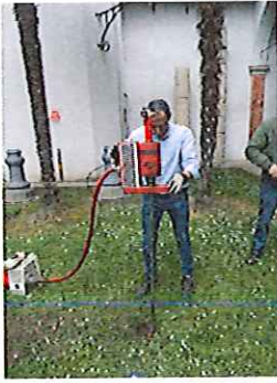
Foto 6 - Preforo e rivestimento (foro DP2). Foto 7 - Prova DP2. Foto 8 - Verifica piezometrica in DP2.
