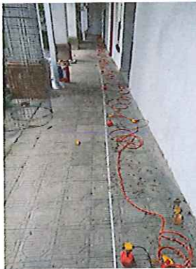
Foto 3 - Controlli piezometrici in DP1. Foto 4,5 - Esecuzione di prova sismica ESAC (stendimento1).
