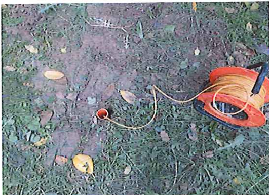
Foto 3 - Controlli piezometrici in DP1. Foto 4,5 - Esecuzione di prova sismica ESAC (stendimento1).
