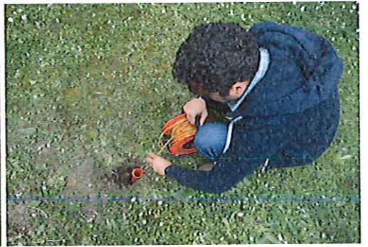
Foto 6 - Preforo e rivestimento (foro DP2). Foto 7 - Prova DP2. Foto 8 - Verifica piezometrica in DP2.
