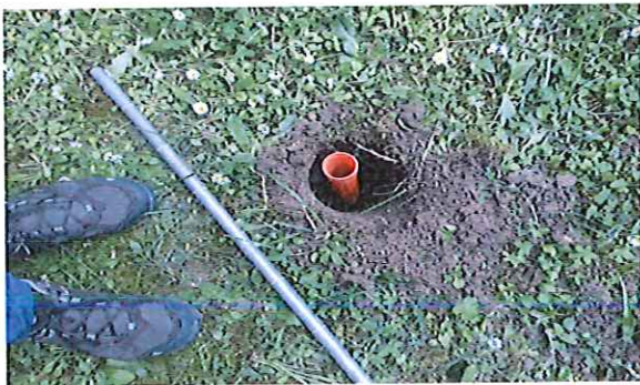
Foto 6 - Preforo e rivestimento (foro DP2). Foto 7 - Prova DP2. Foto 8 - Verifica piezometrica in DP2.
