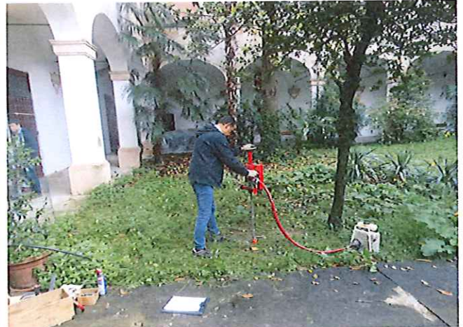
Foto 1 - Preforo a distruzione e rivestimento in pvc. Foto 2- Esecuzione di prova penetrometrica DP1.
