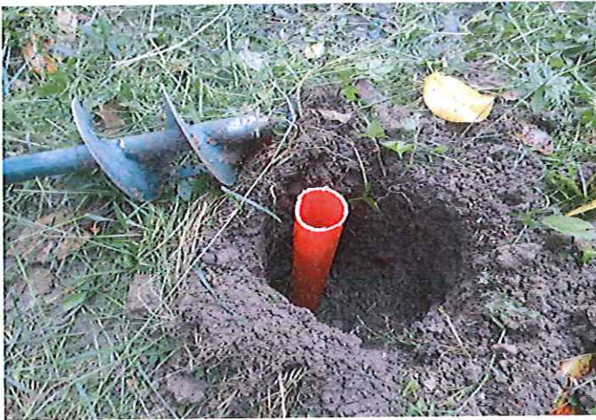
Foto 1 - Preforo a distruzione e rivestimento in pvc. Foto 2- Esecuzione di prova penetrometrica DP1.
