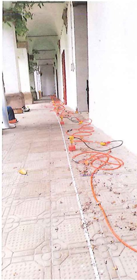
Foto 2: Linea sismica a 24 geofoni in onde P
